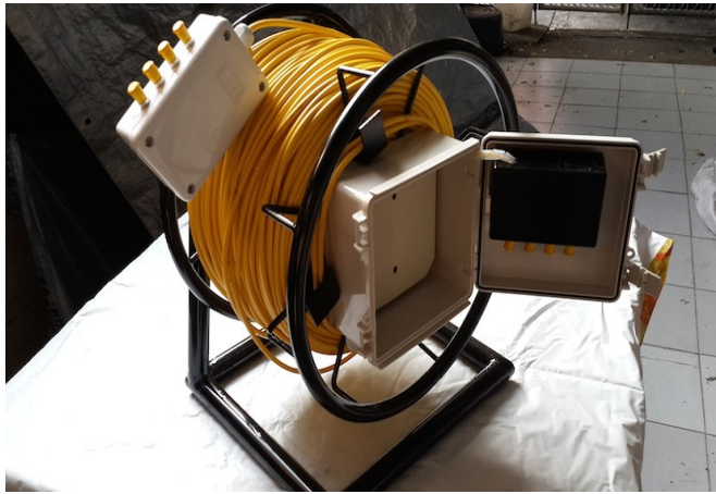
สายไฟเบอร์ม้วนเก็บในโครงล้อเหล็ก
